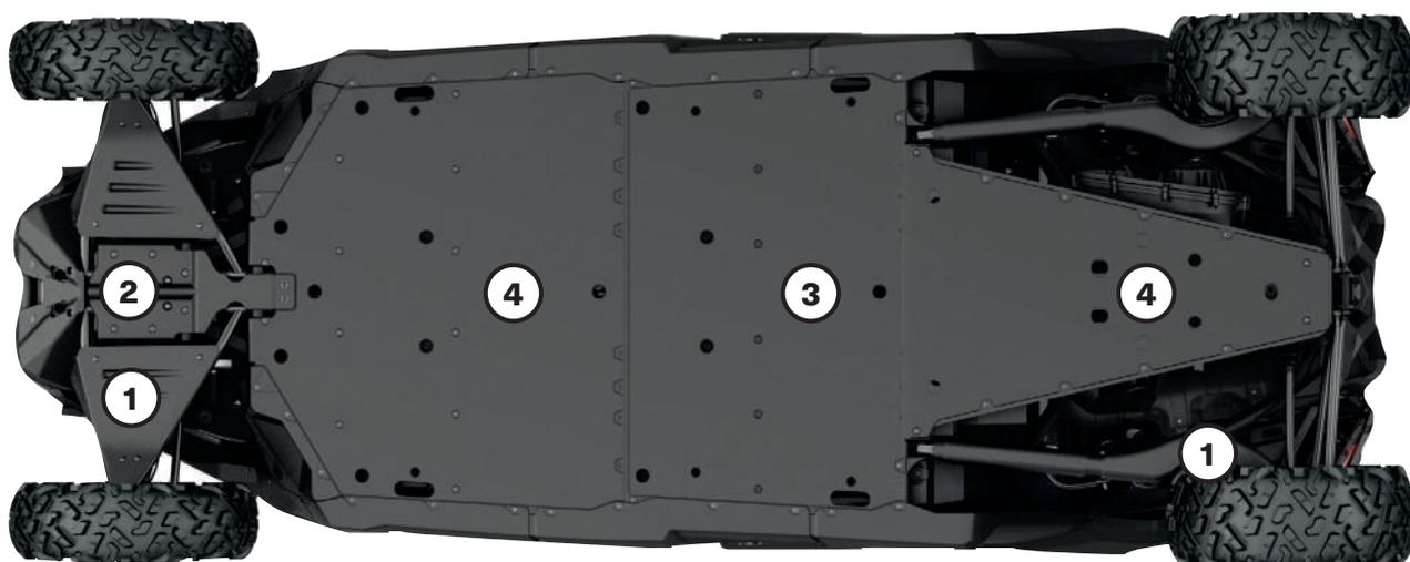
Nos plaques en plastique glissent en douceur et silencieusement sur les obstacles, offrant une grande protection en terrain accidenté. En polyéthylène de masse moléculaire élevée (HMWPE) de 10 mm d'épaisseur, thermoformé et résistant à l'abrasion.
