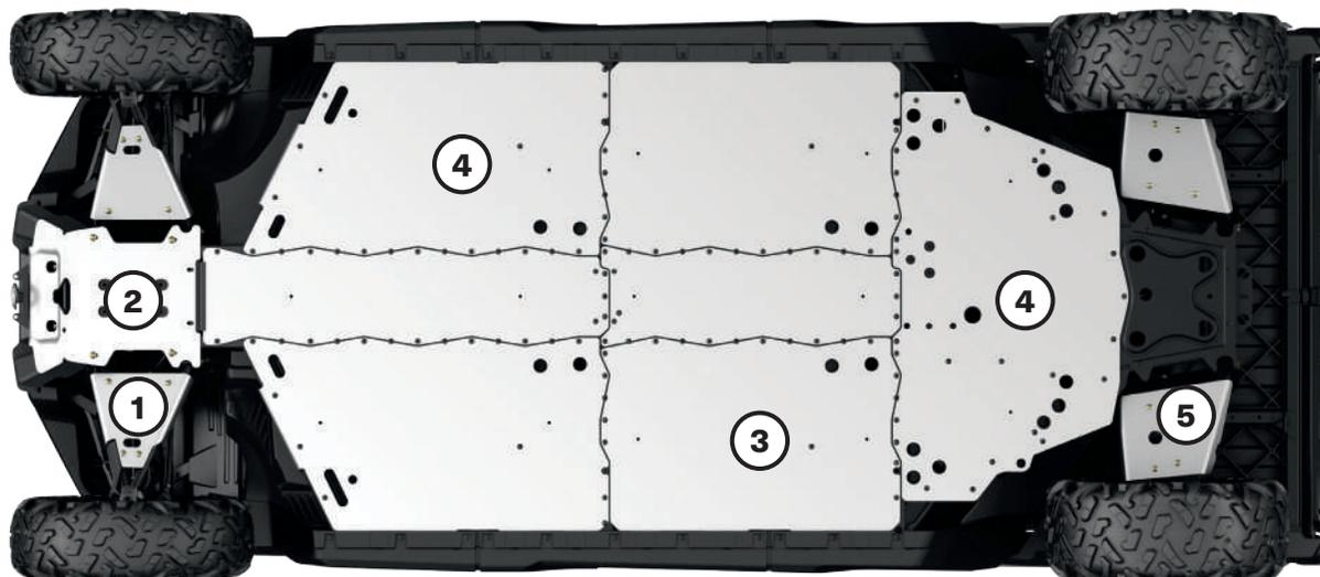
Pour une durabilité et une résistance absolues, toutes nos plaques de protection en aluminium sont en aluminium 5052 H32 haute résistance de 4,5 mm d'épaisseur.
